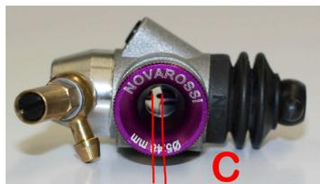
La vite della regolazione del minimo del carburatore e' utilizzata per registrare il passaggio d'aria.
