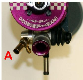
Fate girare in senso orario lo spillo del massimo fino a che non si arresta. Posizione completamente chiusa (non forzare altrimenti la punta dello spillo si potrebbe danneggiare) A.
